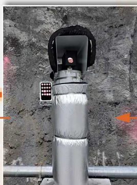
机器视觉智能测量仪 安装在稳固的基座上
